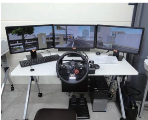
実車のように操作を行い、運転能力を評価する機器。運転反応検査で動作や集中力・判断力のチェックを行ったり、総合学習体験では、案内に従って目
