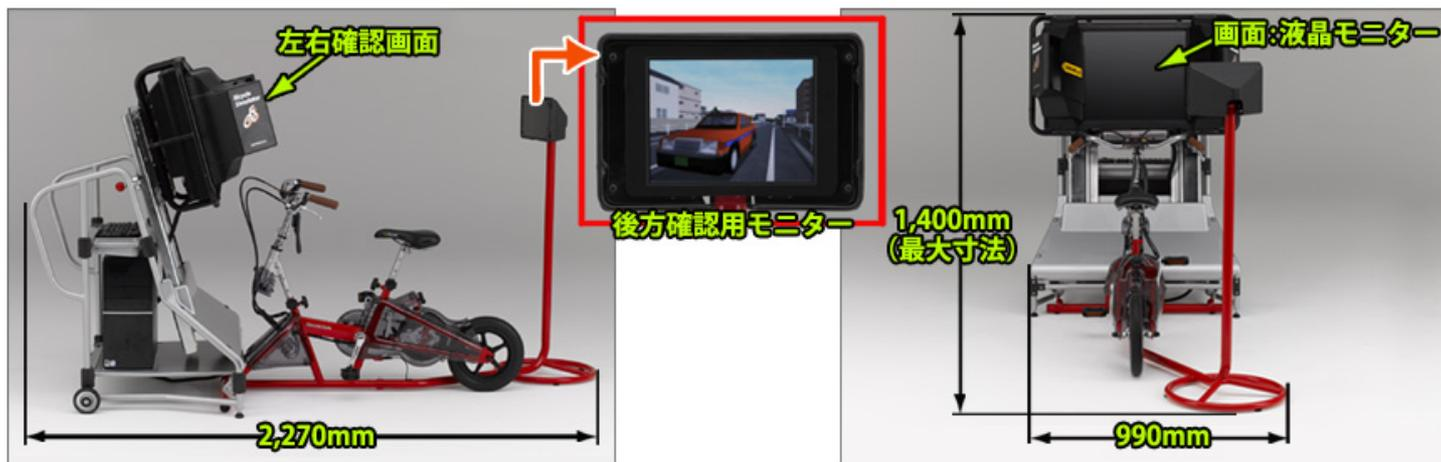
●コンパクト設計(全長:2,270mm×高さ:1,400mm×幅:990mm、重量:88kg)
